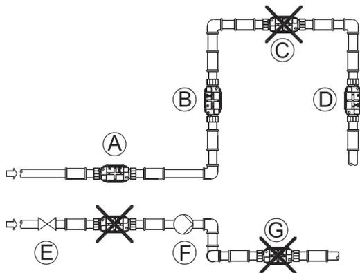
☛ Geeignete Platzierung des Durchflusssensors
