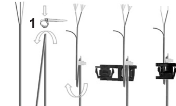
Vorgehensweise bei dünnem Pulsgeberkabel (1) Kabelbinder
